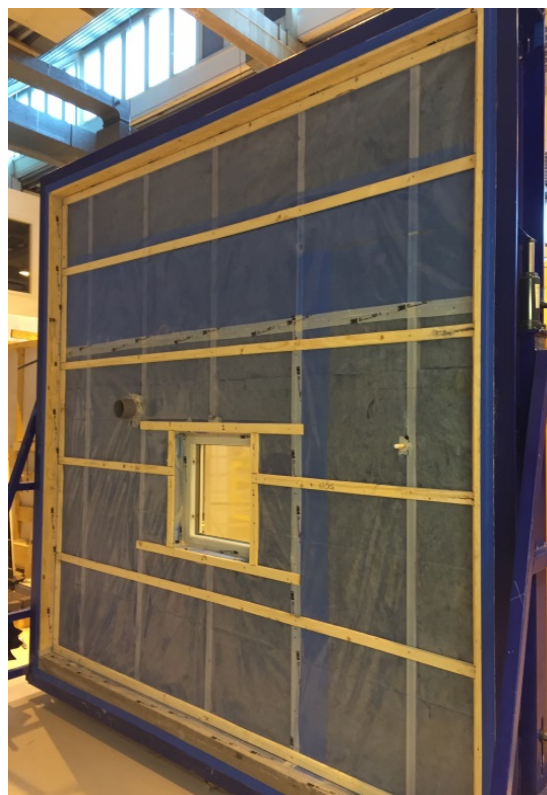
Bild 3. Lufttätetsystem färdigt för provning
