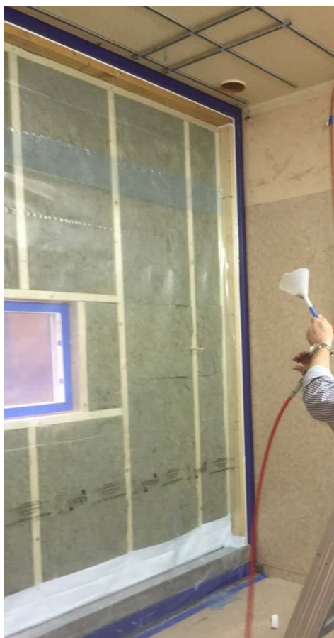
Bild 7. Konstgjort damm "sprutas" mot plastfolien
