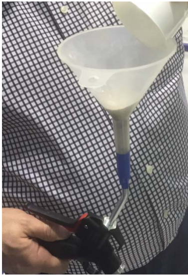
Tratt ansluten till tryckluftpistol och fylld med konstgjort damm
