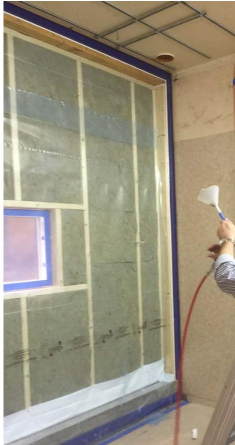
Konstgjort damm "sprutats" mot plastfolien
