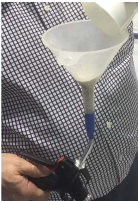
Bild 6. Tratt ansluten till tryckluftspistol och fylld med konstgjort damm
